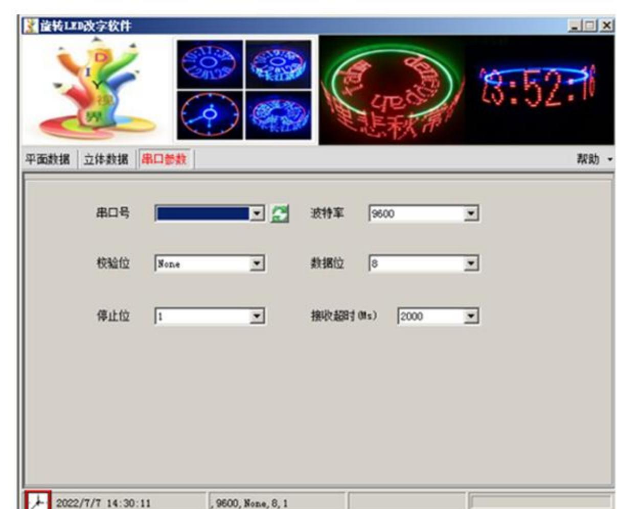
串口参数设置好以后，就可以开始发送数据了。平面数据发送的内容显示在平面上，立体数据发送的内容显示在侧面。
