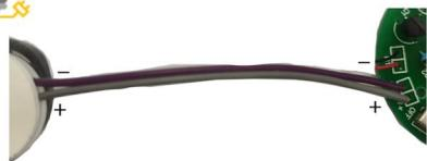
如图将亚克力板上的电源线和板子连接。
